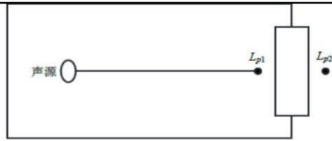
图 4-1 室内声源等效为室外声源图例
