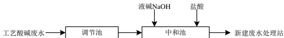
图 4-1 废水处理系统工艺流程图
