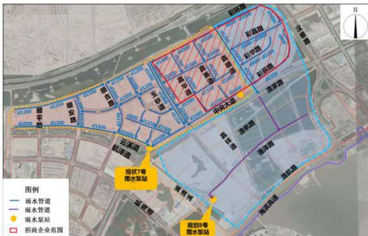
图 1.1-1 区域现状雨水管网情况
