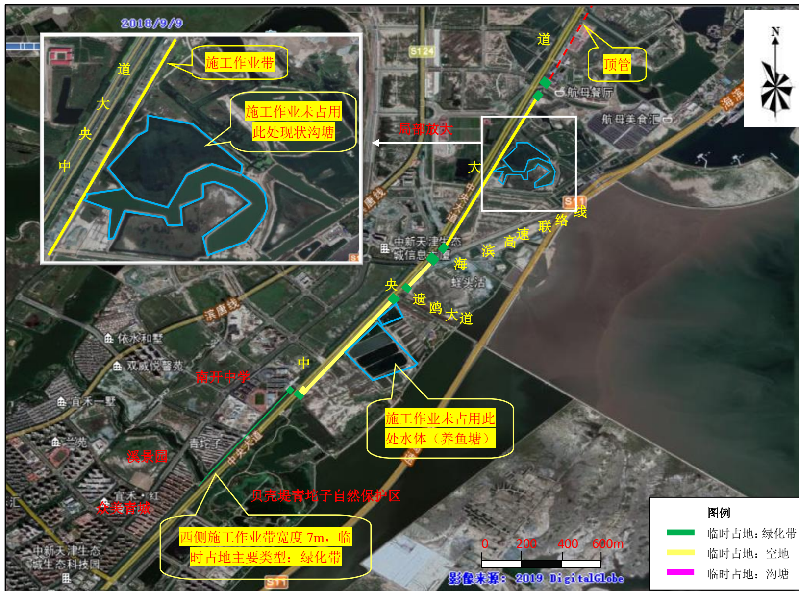
附图 4-1 施工临时占地土地类型分布图 (拍摄日期: 2018.09.09)
