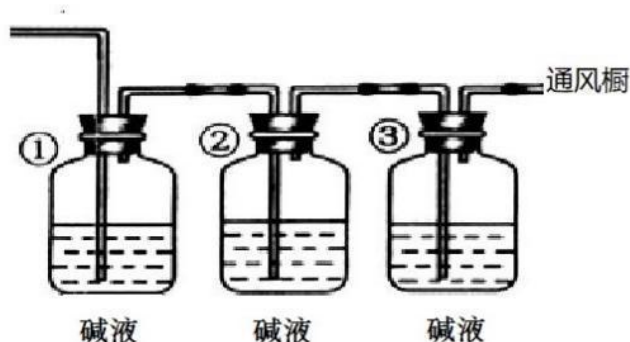
图9 酸性气体碱液吸收装置示意图
