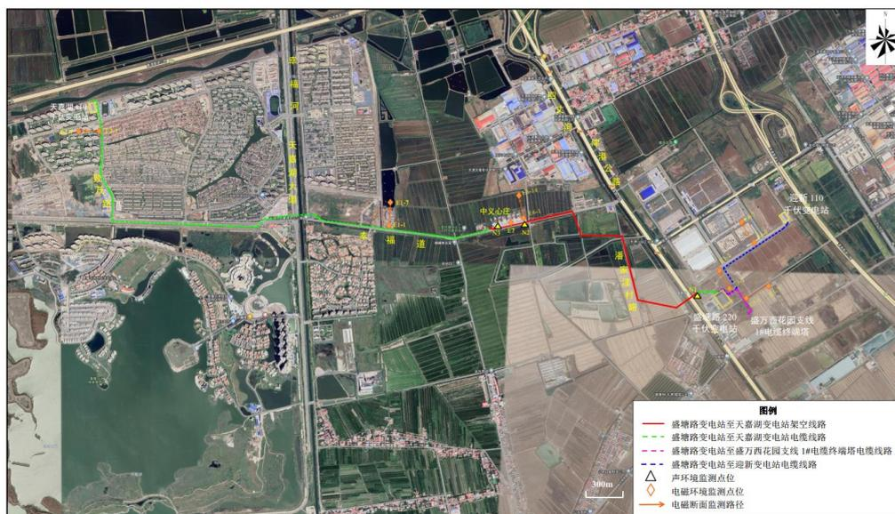
图 5-1 类比线路监测布点图（盛塘路站至天嘉湖站 110kV 单回电缆）
