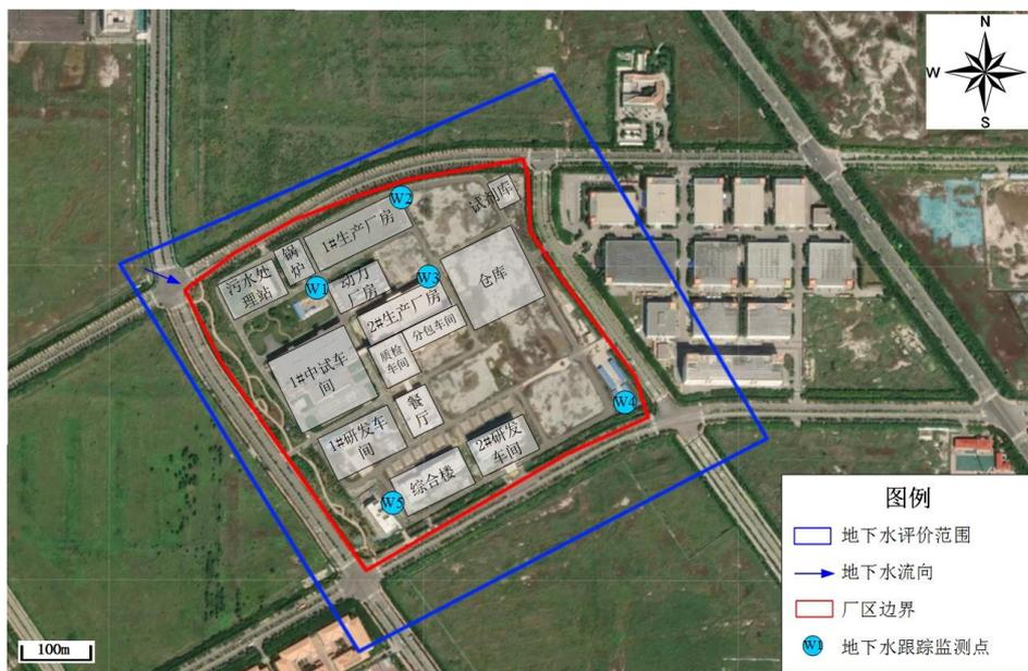
图 9.3-1 项目地下水长期监测井位置示意图
