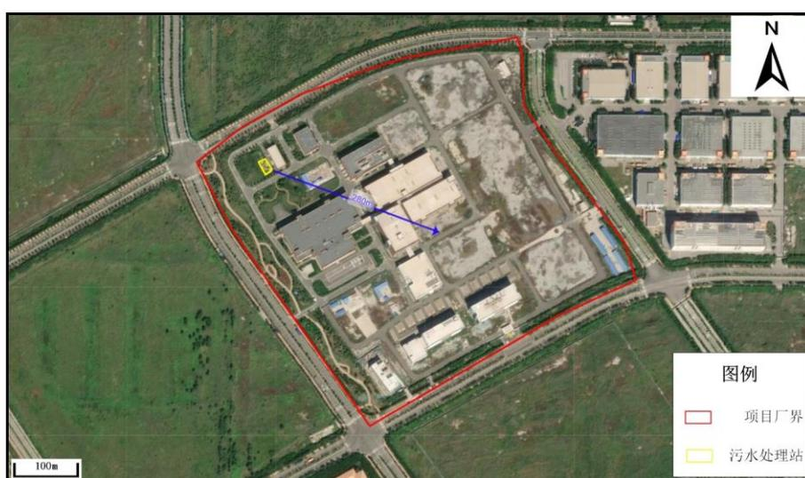
图6.4-4 地下水预测泄漏点位及最大迁移距离示意图
