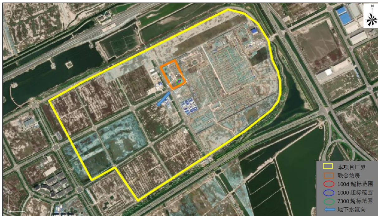
图 6.5-11 污水处理站调节池非正常状况泄漏后镍超标范围预测图
