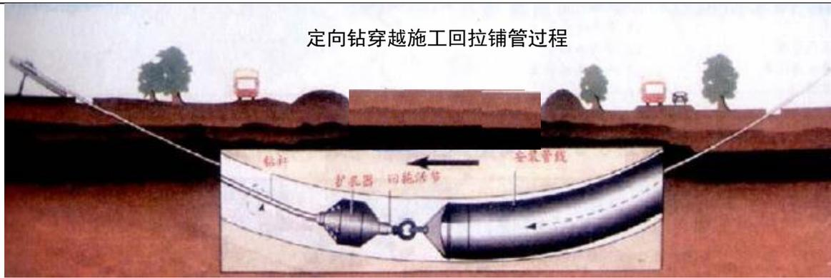
图 5-3 水平定向钻穿越施工断面示意图
